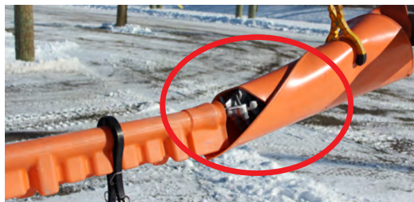
Mauvaise superposition des protecteurs
